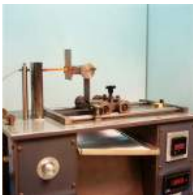
Ensayo del hilo incandescente s/EN 61537: 960°C. Mínimo exigido: 650°C.
