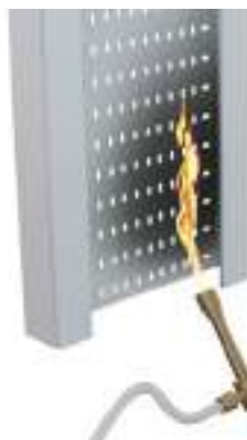
No propagador de la llama s/EN 61537. Inflamabilidad s/UL94: grado V0. No transmiten fuego por goteo. (Espesor de probeta 2,5 mm).
