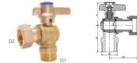
VÁLVULA SALIDA ESCUADRA ROSCA BSP M-H ISO 228/1. Palanca. Tuerca loca. Con retención interior
