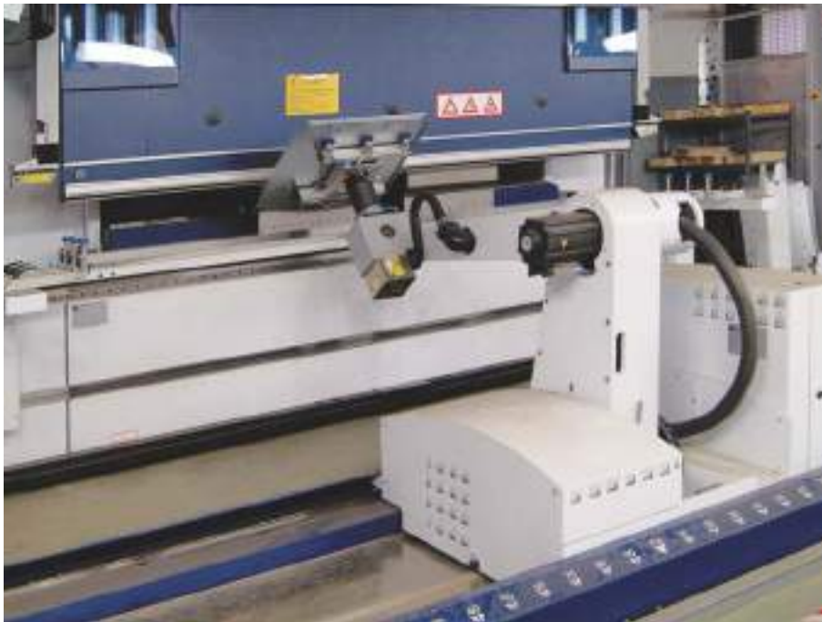
Plegadora con robot / Robotized folding machine.
