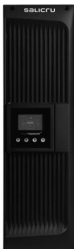
La serie **SLC TWIN RT** es un SAI On-line doble conversión, con factor de potencia de salida 0,9, convertible en formato torre o rack y con posibilidad de configuración en paralelo<sup>(1)</sup>. La gama de potencias cubre desde 700 VA a 10 kVA. El formato rack es muy compacto (con baterías incluidas) de 2U hasta 3 kVA, 3U de 4 a 6 kVA y solo 5U para potencias de 8 y 10 kVA.
