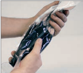
2.- Mezclar componentes Retirar barrera entre los componentes y mezclar convenientemente hasta lograr un color homogéneo de la misma.
