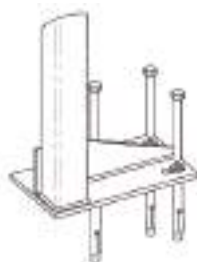
DETALLE C Fijación Bastidor a suelo
