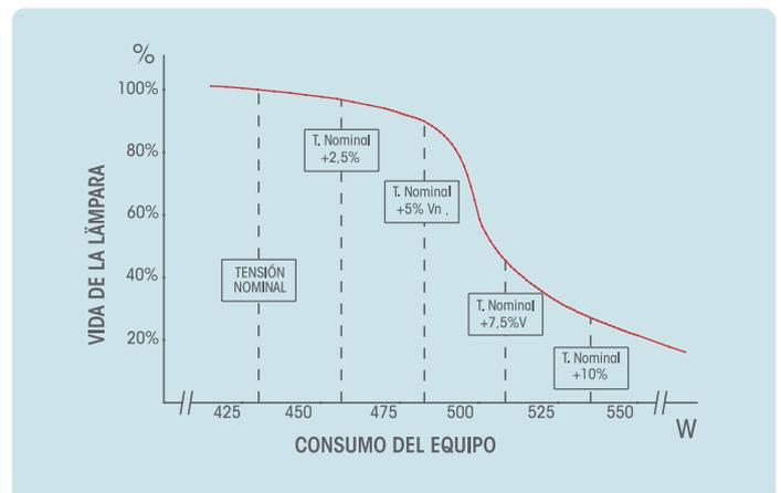
Fig.1: Vida y consumo de la lámpara en función de la tensión de red. (Equipo auxiliar - balasto serie - 400 W Sodio alta presión)
