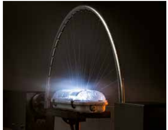
IP room for liquids Sala para IP de líquidos
