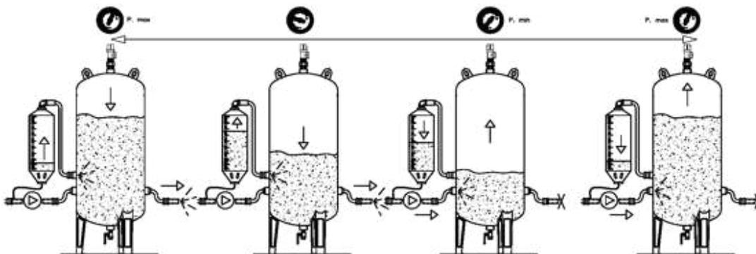
A la hora de seleccionar el volumen del acumulador hidroneumático sin membrana en el lado de **IMPULSIÓN** del grupo de presión, se establece la siguiente equivalencia con los acumuladores hidroneumáticos de membrana,
