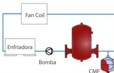
Interiormente disponen de deflectores, que al paso del agua, desvían el flujo en múltiples direcciones, reduciendo su velocidad y presión, favoreciendo la separación de las burbujas de aire, su adherencia a las paredes de los deflectores y tender hacia el punto más elevado del separador, punto a través del cual serán automáticamente liberadas por medio del venteo superior incluido en los equipos.
