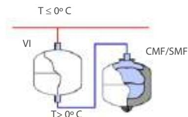
En sistemas **solares** con o sin evaporación se recomienda la instalación o colocación en serie de un vaso intermedio en línea con el vaso de expansión.
