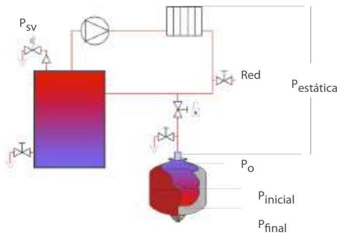
Los vasos de expansión de membrana o diafragma sin transferencia de masa, disponen de una carga fija de aire. Su principio de funcionamiento está basado en la compresión de la cámara de aire en el interior del vaso de expansión cuando se produce un cambio volumétrico en el fluido del circuito de calefacción por la variación de la temperatura del sistema, manteniendo la presión del sistema dentro de límites admisibles.
