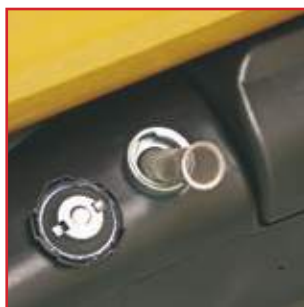
Filtro para llenado del depósito de gasoil
