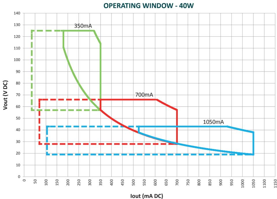
! Cuando los drivers operan permanentemente bajo el rango nominal especificado, el cumplimiento de las normativas IEC debe comprobarse, especialmente en lo que refiere a THD y valores de factor de potencia
