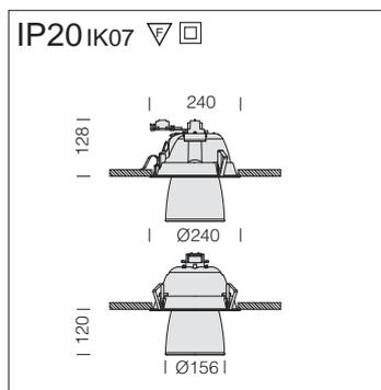
**Cuerpo:** De policarbonato y autoextinguible V2, estabilizado a los rayos UV, antiamarilleo.
