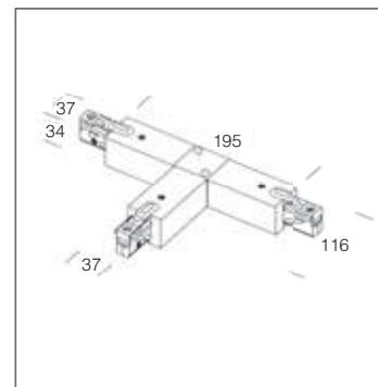
Elemento ya ensamblado, de utilización inmediata. Permite la conexión eléctrica "derecha" y mecánica, para la unión en "T". Se entrega con dos tapas de cierre y cable eléctrico.
