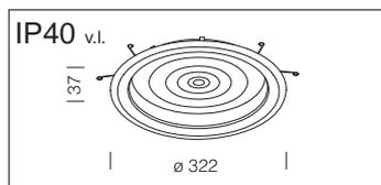
Anillo prismatizado de baja luminancia. De policarbonato metalizado con prismas multiespejo para un mayor control luminoso. Usar con el art. Euro 1.
