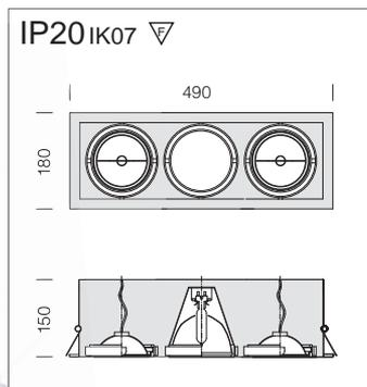
Reflector para CDM-T: de aluminio prismatizado y abrrillantado
