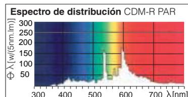
Las lámparas **CDM-R** se han desarrollado para la iluminación decorativa. El consumo de energía y la producción de calor se reducen al menos un 66%, con una duración hasta cuatro veces superior respecto a la lámpara halógena (11000 h de duración media).
