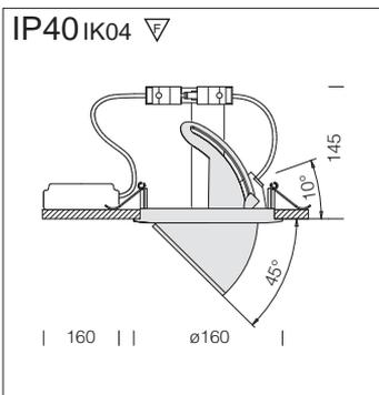
Incluye lámpara y alimentador. Cuerpo orientable de -10° hasta 45°; ahorra energía obteniendo un rendimiento luminoso hasta 11%.
