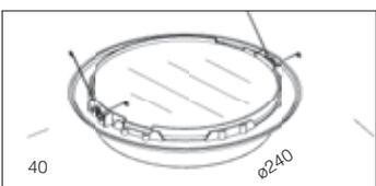
Accesorio con anillo + vidrio + falda opalina para aplicar a Shell 2.
