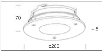
Cristal templado con un espesor de 5 mm acabado serigrafiado. Anillo de Chapa microestirada de protección contra la entrada de insectos, colocado entre el cristal y el anillo. Colocado en Energy 2000 se vuelve IP43.
