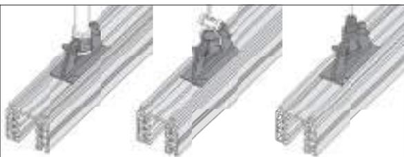
El carril está provisto de una ranura para la instalación directamente al techo sin accesorios o en suspensión. Mediante la ranura se puede realizar:
