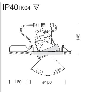
**Reflector:** de aluminio prismaticado y abrigantado de alto rendimiento.- se ha mejorado el mantenimiento luminoso (hasta dos veces más)
