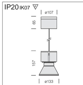
**Vision A+M - con conexión de cable**
