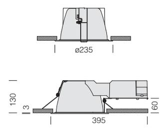
**Reflector:** De policarbonato, autoex-tinguible V2, metalizado con polvos de aluminio a alto vacío con procedimiento de C.V.D. para un mayor control y rendimiento de la luz. Con borde negro opaco.
