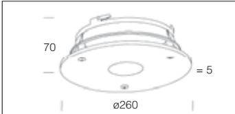
Cristal templado con un espesor de 5 mm acabado satinado. Anillo de chapa microestirada de protección contra la entrada de insectos, colocado entre el cristal y el anillo. Colocado en Energy 2000 se vuelve IP23.
