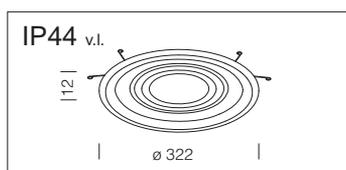
Anillo con vidrio serigrafiado introducido en la parte interior. Usar con el art. Euro 1 obteniendo IP44.
