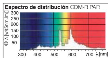
Las lámparas **CDM-R** se han desarrollado para la iluminación decorativa. El consumo de energía y la producción de calor se reducen al menos un 66%, con una duración hasta cuatro veces superior respecto a la lámpara halógena (11000 h de duración media).
