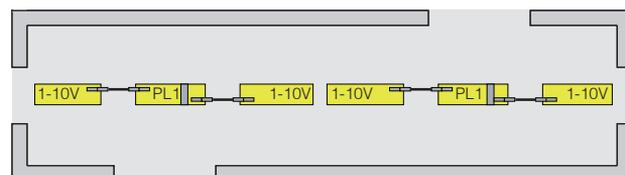
Juego de regulación manual y precisa que la mayoría de las fuentes de luz gracias a DALI (**1 o 2 DALI MCU activa y hasta 2 DALI MCU pasivas = hasta 4 puntos de funcionamiento**). Con 2 DALI MCU activos puede controlar hasta 50 componentes DALI
