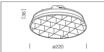
Pantalla tipo rejilla de policarbonato metalizado para un mayor control luminoso.
