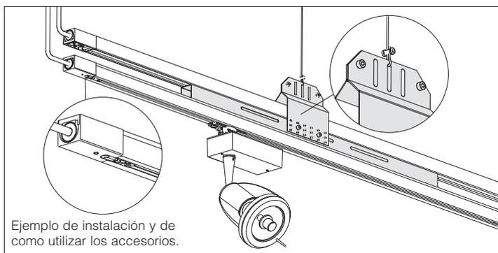
Esta estructura se logra utilizando accesorios especiales con el carril OMNITRACK. El carril doble tiene la característica principal de que se puede utilizar como carril electrificado en la parte baja, para proyectores de luz de acentuación; y como sistema de sustentación para apoyar una lámpara de cielo, que pueda dar luz general al ambiente.
