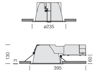
**Reflector:** De policarbonato, autoex-tinguible V2, metalizado con polvos de aluminio a alto vacío con procedimiento de C.V.D. para un mayor control y rendimiento de la luz. Con borde blanco.
