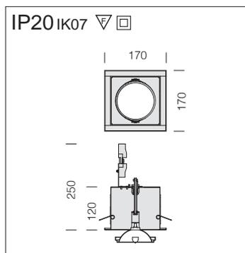
**Reflector:** de aluminio prismatizado y abrillantado de alto rendimiento.
