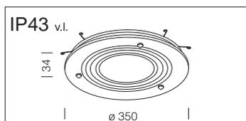
Anillo con vidrio serigrafiado y chapa microestirada de protección contra la entrada de insectos, colocado entre el cristal y el anillo. Usar con el art. Euro 1 obteniendo IP43.
