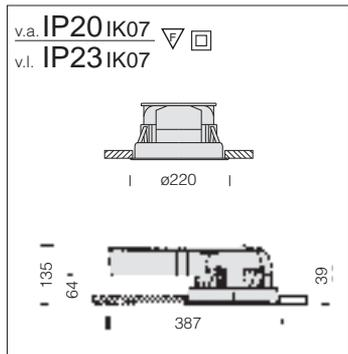
**Cuerpo:** De policarbonato irrompible y autoextinguible metalizado con polvos de aluminio muy puro a alto vacío con procedimiento de C.V.D.
