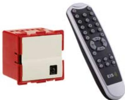
**MÓDULO DE AMPLIACIÓN CON FM Y 4 CANALES QUE SE MANEJA CON UN
