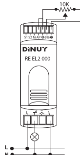
Ejemplo Nº 2: con Potenciómetro
